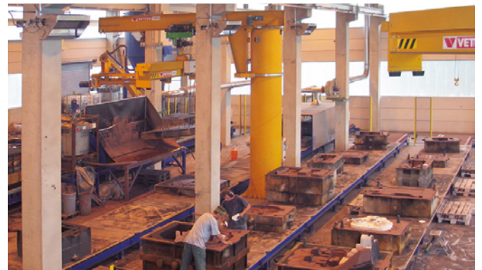
Kaltharz-Formanlage, Formvolumen 2200 x 1600 x 1500 mm
