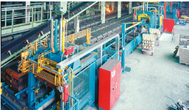
HWS-Hochdruckpress-Formanlage Formvolumen 900 x 800 x 600 mm Vollautomatisiert
