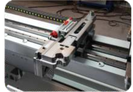
Automatische Blechstärkenmessung zur Übergabe an die Steuerung (Option)
