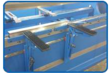
Vorderansläge mit Bürsten Oberfläche, verschiebbare auf Linearführung und in der Höhe verstellbar
