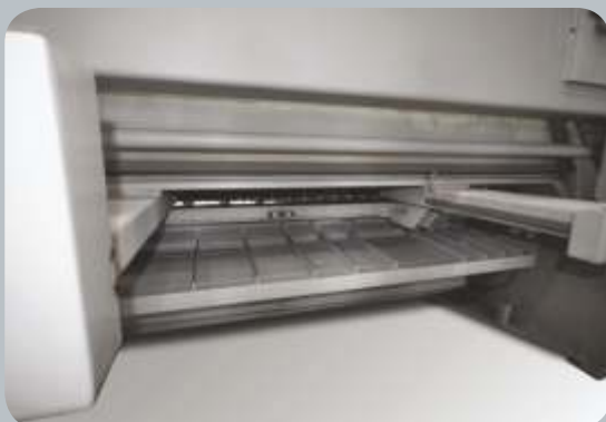
Position 2: Die Hochhaltevorrichtung fährt während des Schneidvorgangs 150mm parallel nach unten und übernimmt das geschnittene Blech. So wird es nicht durch sein Eigengewicht verbogen (ähnlich Eselsohlen) oder fällt auf den Boden.
