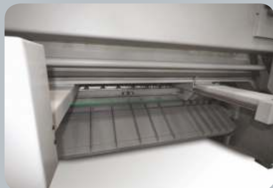
Position 3: Danach schwenkt die Hochhaltevorrichtung schräg nach unten, dadurch rutscht das Blech auf den Boden oder auf eine Palette.
