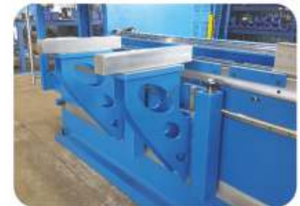
CNC Vorderanschlag (Biegehilfe), automatische Höheneinstellung (Option)
