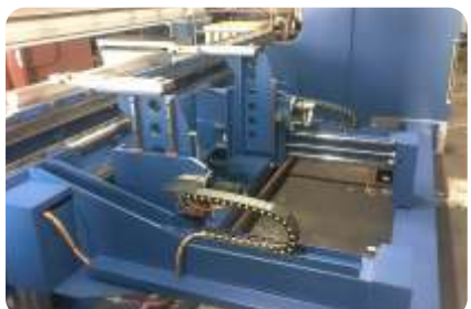
6-Achsen Hinteranschlag, X1-X2-R1-R2-Z1-Z2 (Option)
