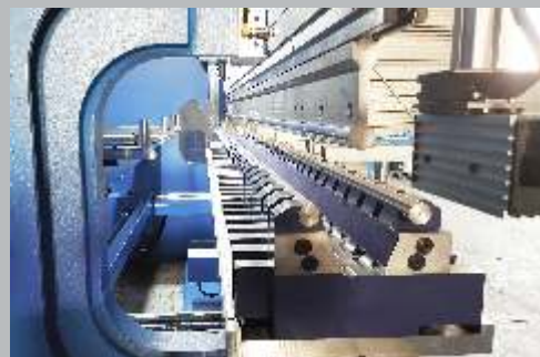
Sonderwerkzeug: Einstellbare Matrize, V=25 - 400mm
