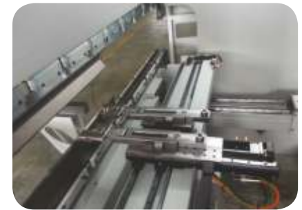
5-Achsen Hinteranschlagssystem, X-X'-R-Z1-Z2 mit Funktion Delta-X inklusive (Option)
