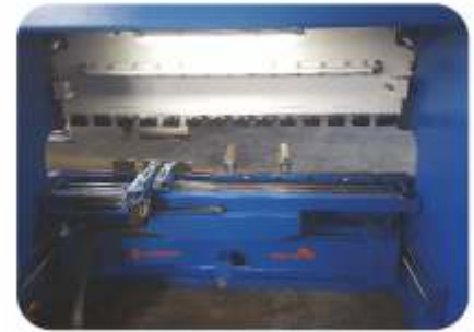
Freier Raum auf der Maschinenrückseite durch Positionierung der Anschlagführung auf der Innenseite des Maschinengestelles
