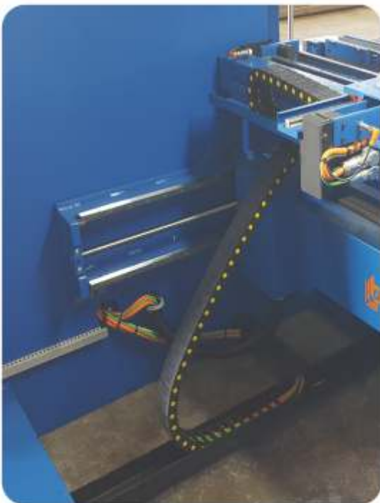
Hinteranschlag mit doppelten Linearführungen und verschleißfreien, bürstenlosen Antrieben.
