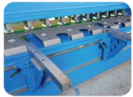
Verschiebbare Vorderanschlage auf Linearfuhrung (Option).
