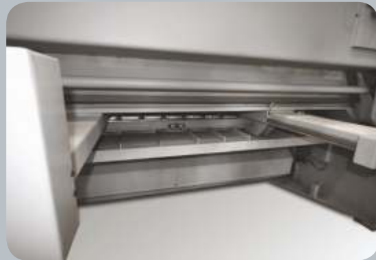
Position 1: Dank der Hochhaltevorrichtung wird das Blech am Anschlag unterstützt und kann so genau angeschlagen werden.
