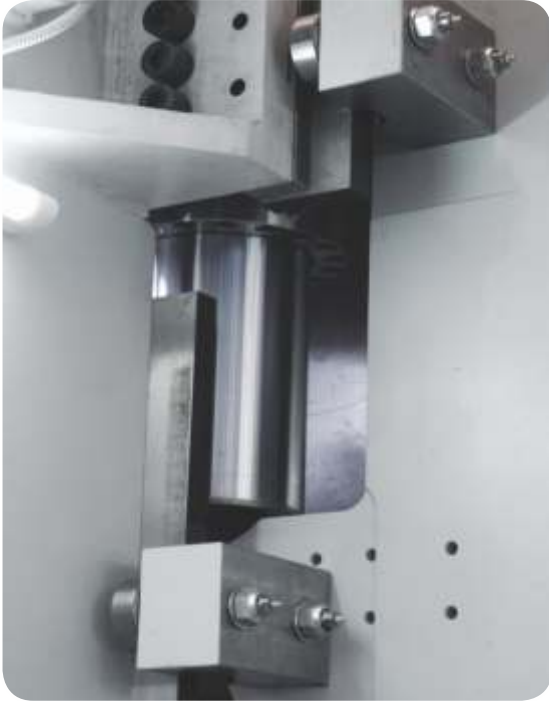
Obere und untere Doppelrollenführung für ein schnelles und präzises Verfahren der Biegewange.
