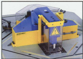
LB 13 / Quick Schnellwechsel-System der Messersätze
