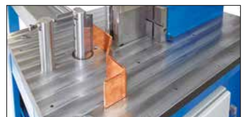
Messprisma mit automatischer Winkelkorrektur und abdruckfreiem Biegen für Kupfer, Aluminium und Stahl
